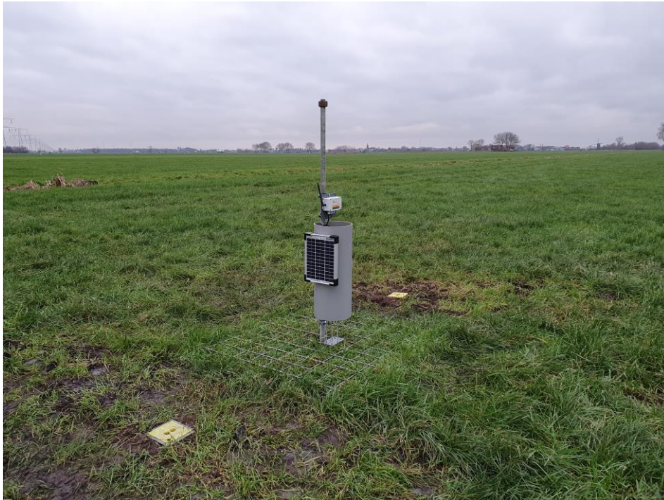
Figuur 16. Foto van VSM-sensor op proefperceel bij Kees Baan. Twee grondwater-peilbuizen ondiep en diep staan in directe omgeving ervan.
