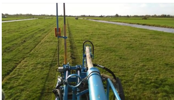
Figuur 1.2 door de rechtrijlaser zeer rechte drains
